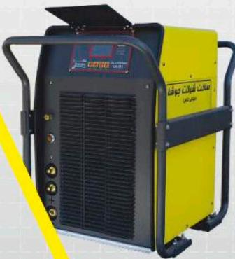
این گل میخ‌ها به وسیله دستگاه جوش قوس الکتریکی خاصی که Stud Welder خوانده می‌شود به بال تیرهای سازه‌ای جوش می‌شود. این فرآیند جوشکاری می‌تواند هم به صورت مستقیم روی بال تیر سازه‌ای انجام گیرد (Direct Attach Welding) و هم از روی ورق فولادی انجام گیرد (Through the Sheet Welding) قبل از قرارگیری گل میخ یک حلقه سرامیکی در محل جوش قرار می‌گیرد تا از حوضچه مذاب ایجاد شده در لحظه ایجاد قوس الکتریکی محافظت نماید.
